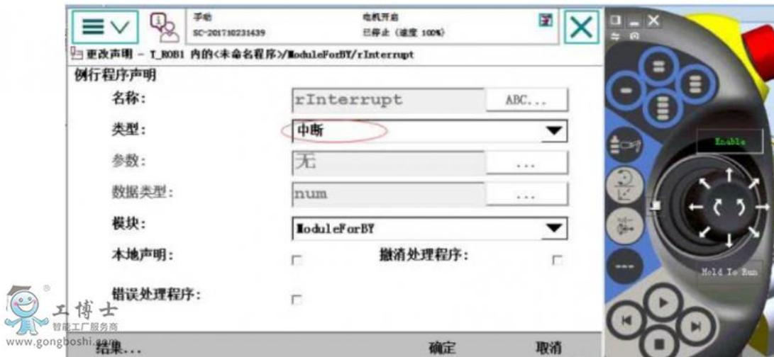
1. 新建例行程序，設定名稱，類型選擇“中斷”，然後單擊“確定”。
