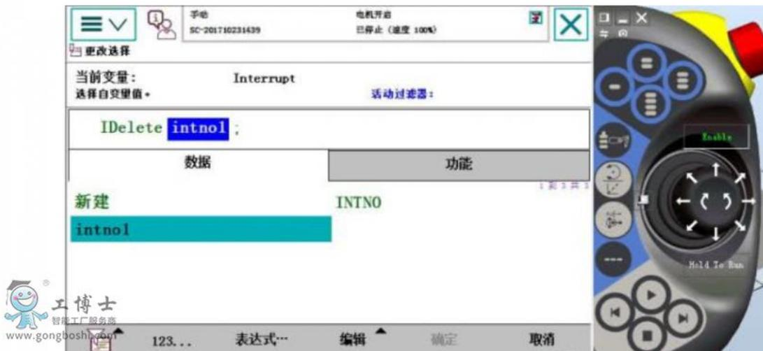
3. 在例行程序“InitAll()”中，添加指令“IDelete”（取消指定的中斷）。
